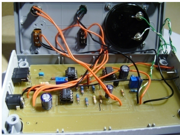
Figura 61 - Interior do Sonómetro após a montagem de todos os acessórios.
