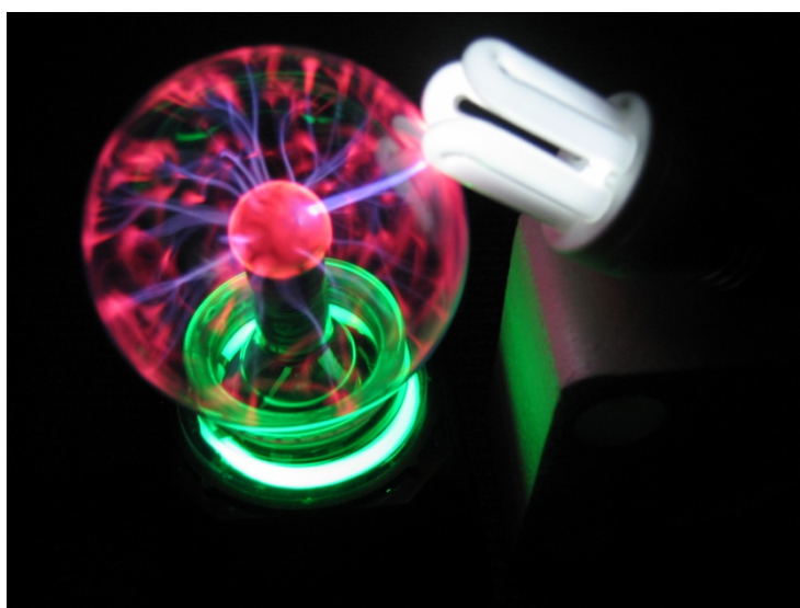
Figura 32 - Lâmpada fluorescente acesa pelo campo eléctrico não uniforme.
