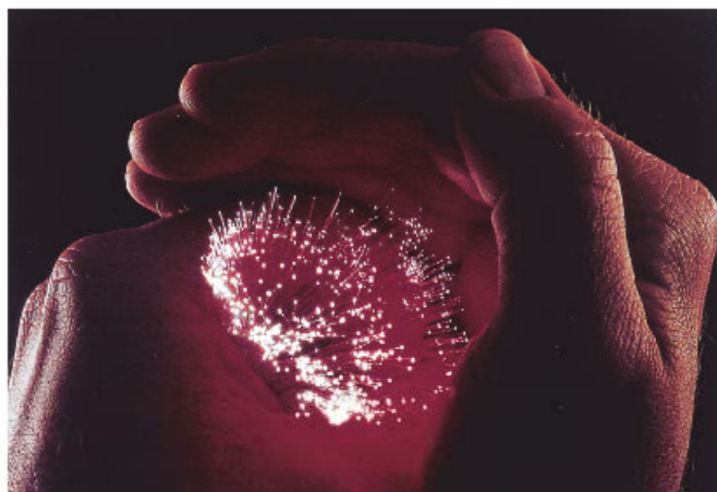
Figura 50 – Iluminação das pontas das fibras ópticas, verificando a transmissão da luz ao longo das mesmas.
