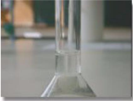
Completar até ao traço, primeiro com o frasco de esguicho e depois com a pipeta pasteur. Evitar erros de paralaxe na observação do menisco da solução.
