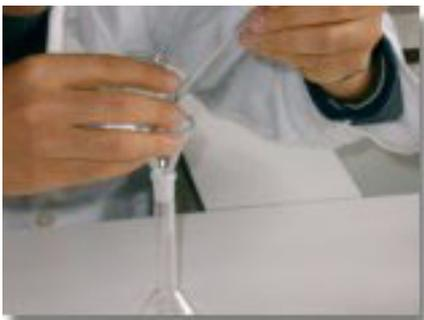
Com o auxílio do funil, decantar a solução para o balão volumétrico, lavando o copo de precipitação para dentro do balão.
