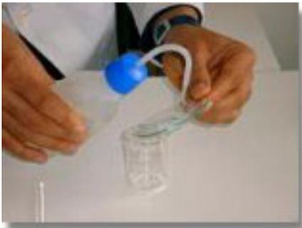
Lavar o vidro de relógio com água destilada para dentro do copo de precipitação.
