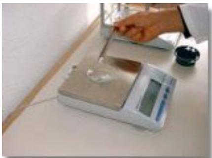
Medir a *quantidade adequada* de tiosulfato de sódio pentahidratado na balança electrónica.
