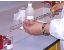
5.3- Colocar a bureta no suporte e despejar a solução de lavagem para um copo de restos devidamente identificado.
