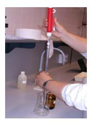
5.7- Adicionar 3 gotas de um indicador ácido base apropriado.
