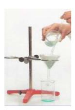
Filtrar a mistura constituída, agora, pela solução aquosa de sulfato de cobre(II) e enxofre cristalizado.
