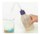
Adicionar uma certa quantidade de água à mistura constituída por areia, sulfato de cobre(II) e enxofre cristalizado.
