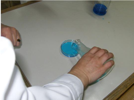
**7- Coloque uma caixa à temperatura ambiente e outra a uma temperatura mais elevada de modo a favorecer uma evaporação mais rápida do solvente.**
