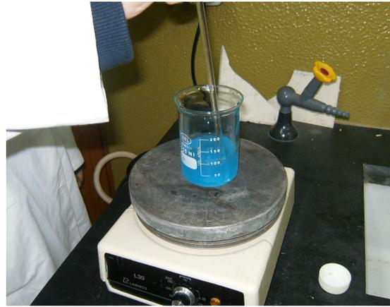
**4 - Dissolva a quente o sulfato de cobre até à saturação.**
