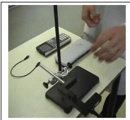
Montar a célula fotoelétrica junto à base do suporte usando a outra noz.
