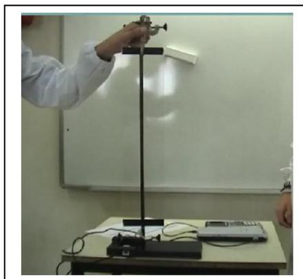
Repetir novamente os passos de 6.3 a 6.9, utilizando duas placas de acrílico ligadas uma à outra, com fita adesiva e medir a respectiva massa ( $m_2$ ).
