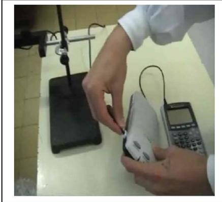
Ligar a célula fotoelétrica ao CBL2 e este à máquina de calcular gráfica.
