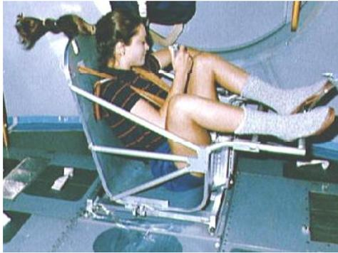
Na figura mostra-se o dispositivo com uma rapariga fazendo um teste, na Terra. A constante elástica do sistema era  $2526 \text{ N m}^{-1}$ . A rapariga sentou-se na cadeira, com  $4,0 \text{ kg}$ , e foi colocada em oscilação. O período registado foi de  $0,97 \text{ s}$ , com uma amplitude de  $15 \text{ cm}$ .
