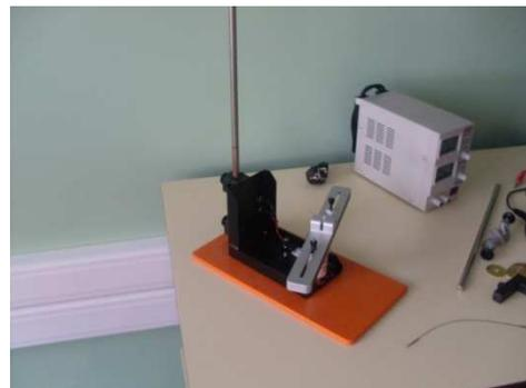
2. Fixar a photogate à base do aparelho usando o parafuso adequado.
