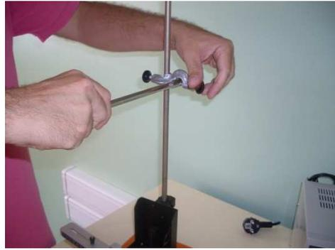
4. *Deslizar o sensor de força através da haste e fixá-lo através do parafuso superior.*
