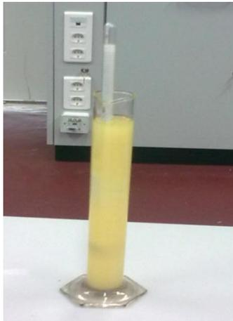
Medir a densidade do biodiesel obtido e comparar com a densidade do biodiesel fornecido.
