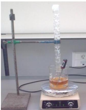
Efectuar a montagem indicada, colocando um agitador magnético dentro do balão. Aquecer, durante uma hora a uma temperatura entre os 65 e os 68°C, com agitação.
