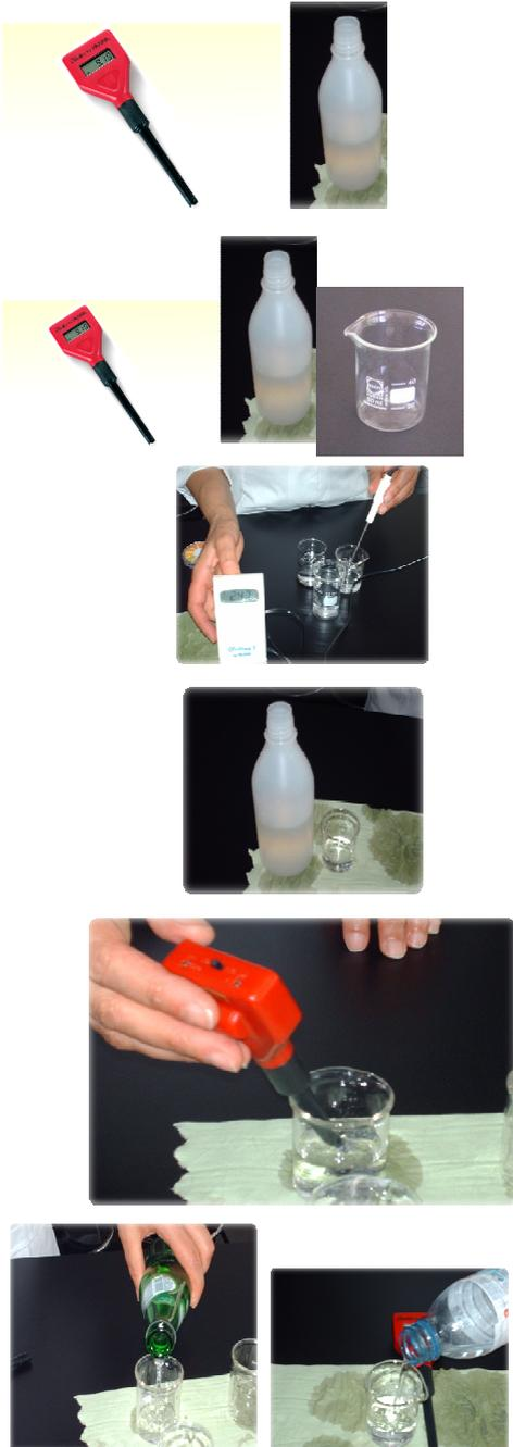
1.- Calibrar o aparelho medidor de pH; tendo em atenção as instruções que acompanham o aparelho.
