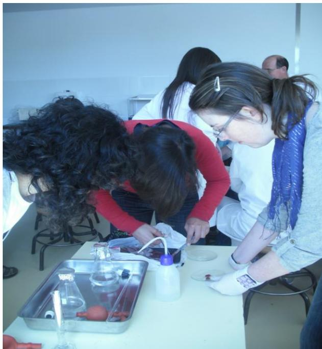
6. Verta o conteúdo do tubo 1 no frasco do sensor de O<sub>2</sub>, tendo o cuidado para que este não entre em contacto com o fígado e coloque imediatamente o sensor.
