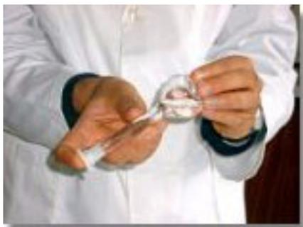
Homogeneizar a solução, invertendo várias vezes o balão volumétrico tapado.
