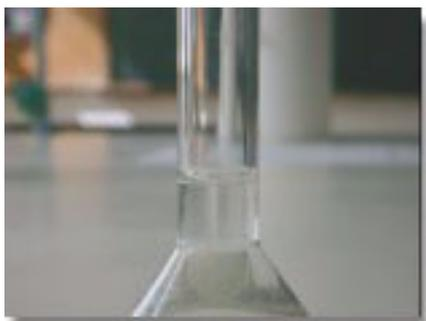
Completar até ao traço, primeiro com o frasco de esguicho e depois com a pipeta pasteur. Evitar erros de paralaxe na observação do menisco da solução.
