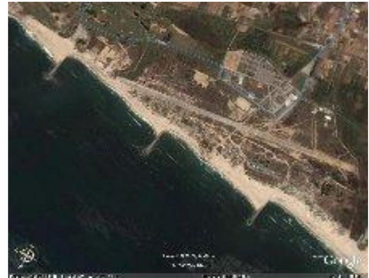
**Esporões** - Estrutura rígida de engenharia costeira, disposta transversalmente ao desenvolvimento da linha de costa, e que normalmente é utilizada na protecção contra a erosão costeira.
