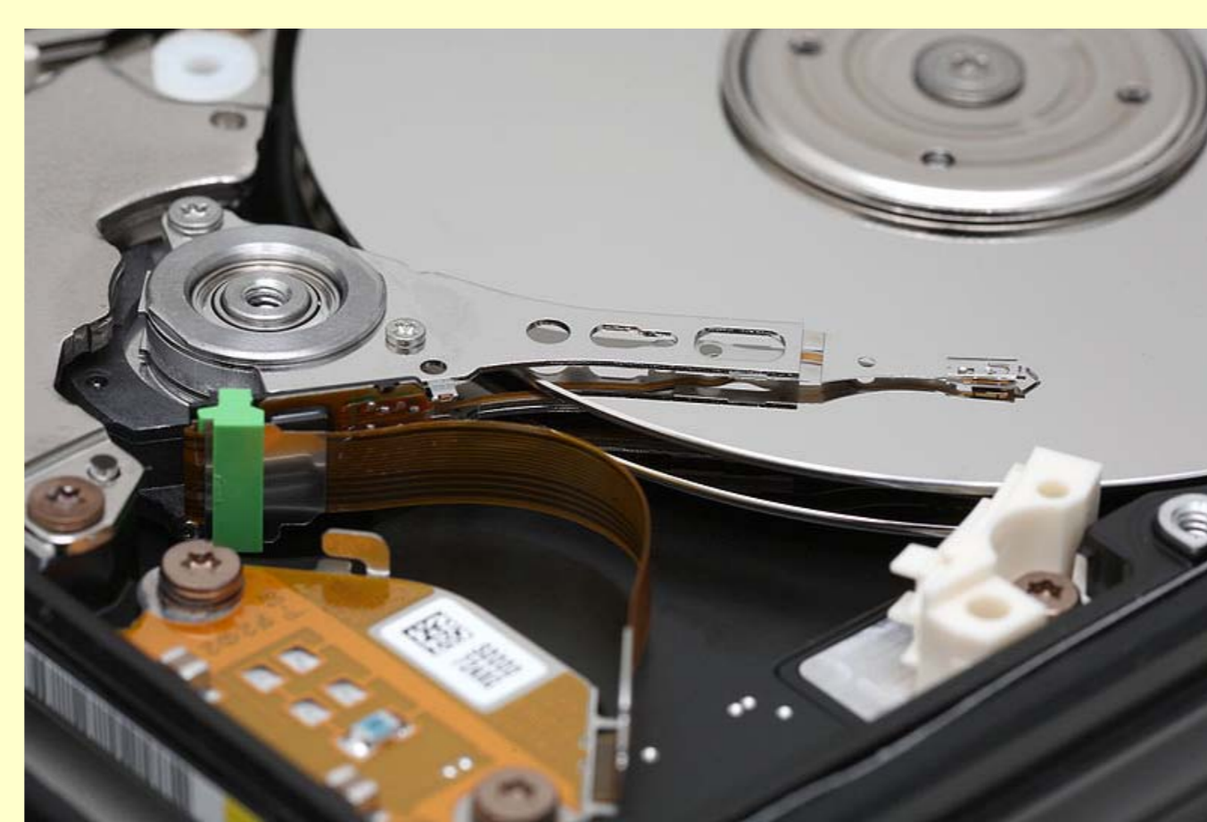
Os discos duros modernos utilizam o GMR.
